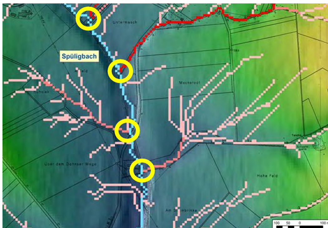
Abb. 32: Ermittlung möglicher Eintrittspfade über "Fließwege" am Spüligbach
