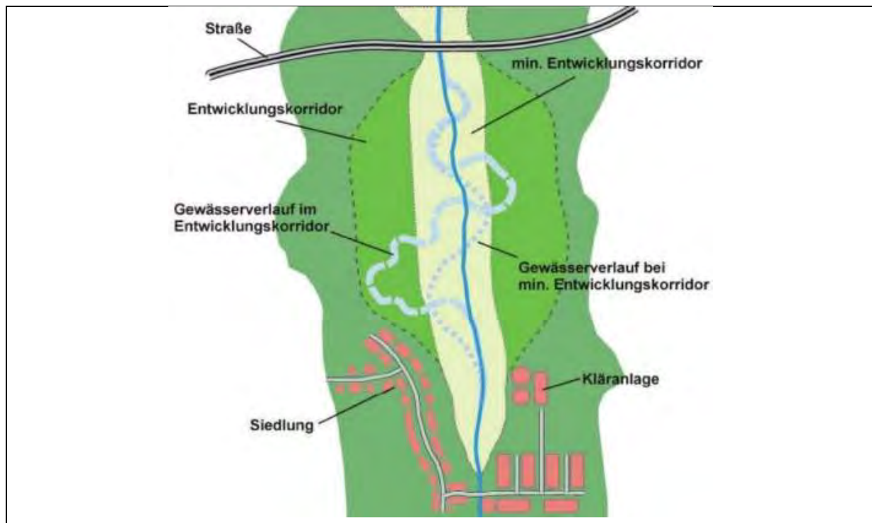
Abb. 45: Ermittlung eines Entwicklungskorridors für die gewässertypkonforme Entwicklung (MUNLV NRW 2010)
